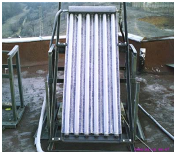
Фиг. 4. Слънчев колектор със заскрежена повърхност.
